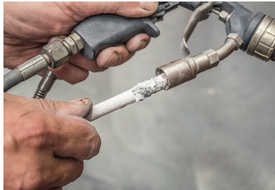
Nur sauberer Lack kommt Dank dieses ganz einfach zu wechselnden Filters auf der Oberfläche an
